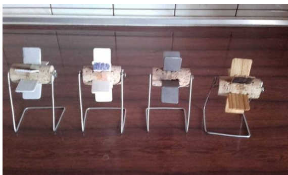
Slika 1: a) Mlinčki iz stiropora, plastike in železa. b) Delovanje modela mlinčka.
